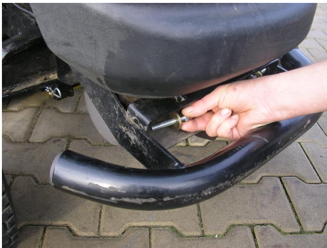
1. Ersetzen Sie die originalen Stoßstangenschrauben durch längere Schrauben.
