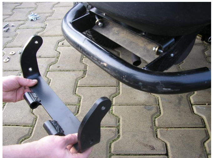
2. Montieren Sie den vorderen Rahmen unter die Stoßstange
