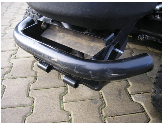
3. Befestigen Sie die Schrauben ohne Muttern.
