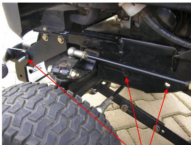
4. Z levé strany traktoru nasadíte na tyto 3 připravené otvory levý díl rámu bez háku.
