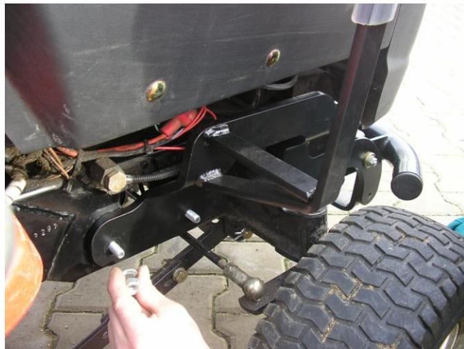
6. Z pravé strany traktoru přichy'te pravý díl rámu s hákem. Nasad'te matky a lehce dotáhněte.
