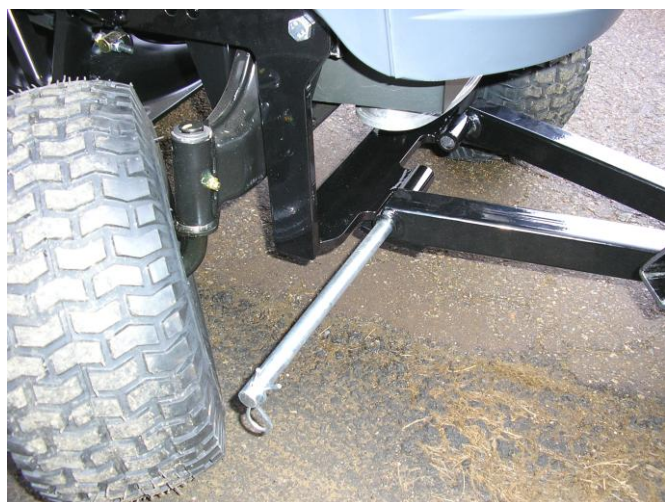
9. Po dotažení rámu přiložte smontovanou sněhovou radlici. Kola vytočte do max. pravého rejdu. Radlici zajistěte čepem a závlačkou.
