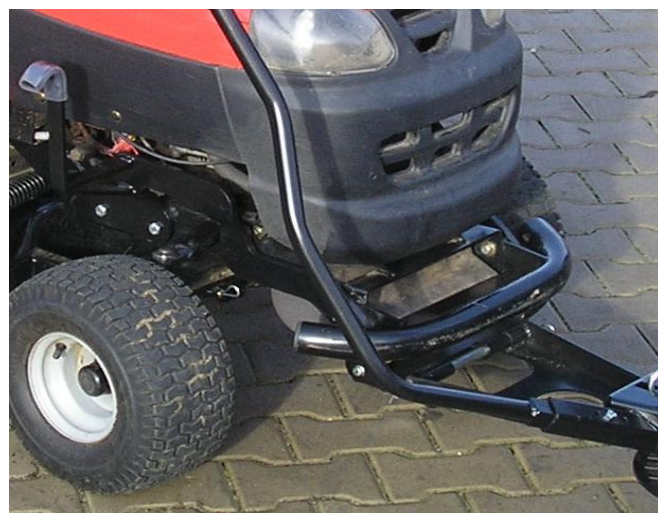
10. Zajištěná radlice na rámu traktoru s nasazenou ovládací pákou.
