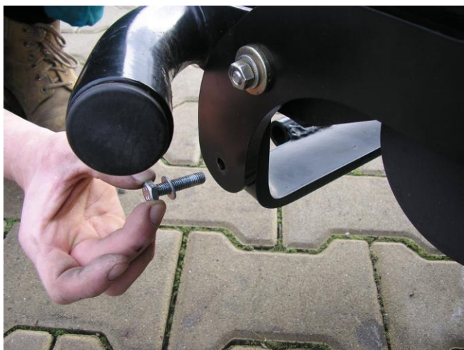
7. Přimontujte přední díl rámu do zbylých děr bočních dílů rámu.
