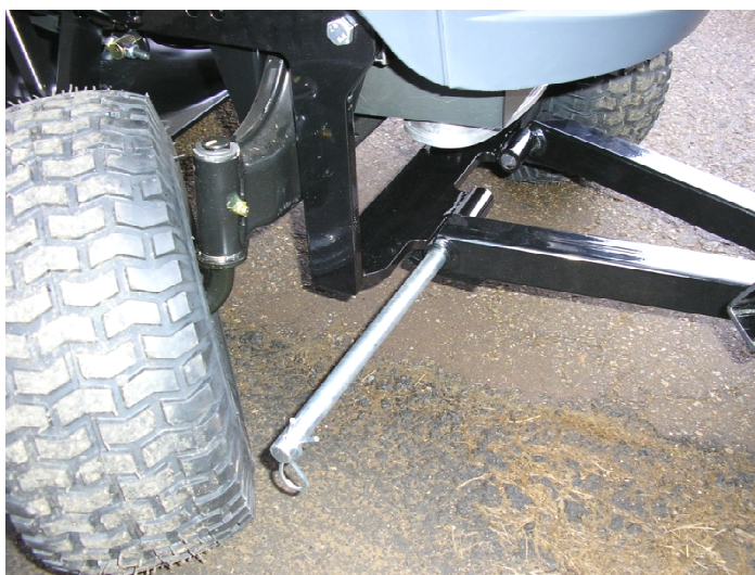
9. Kola vytočte do max. pravého rejdu. Radlici zajistěte čepem a závlačkou.
