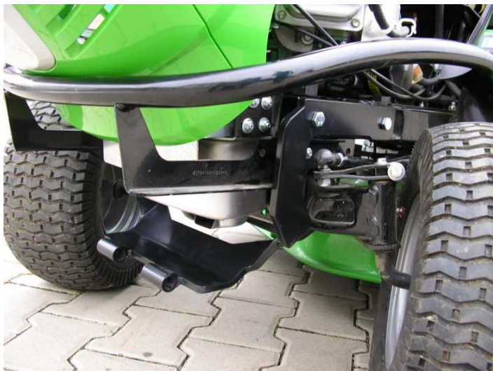
5. Rám přimontujte na levé straně traktoru kratšími šrouby (Nedotahovat.) Matky a podložky umístěte uvnitř šasí.
