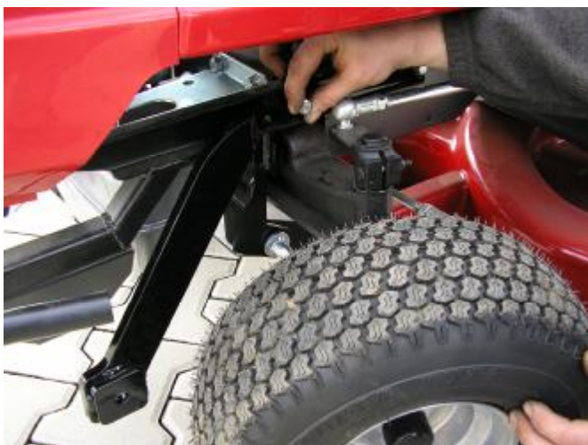
3. Vorgang auf der linken Seite des Traktors wiederholen, das Loch an der Lenkstange mit einer Senkschraube versehen. Wieder nur leicht anziehen!
