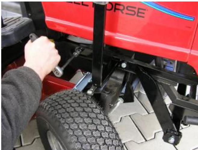
7. Zum Schluss alle Schrauben der Seitenteile sorgfältig festziehen.
