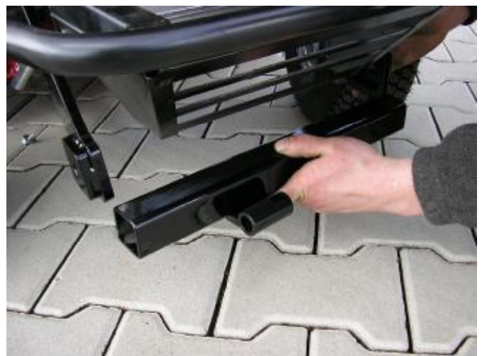
4. Zwischen die montierten Seitenteile das Teil mit Halterungen für das Schneeräumschild einsetzen. Die Halterungen müssen nach vorne zeigen und sich am unteren Teil des Bauteils befinden.
