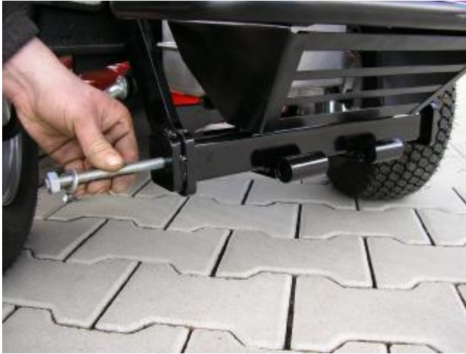
5. Bolzen durch die Seitenteile stecken und mit Mutter und Unterlegscheibe sichern.
