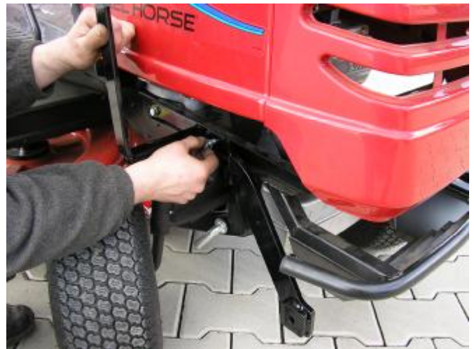
2. Seitenteil des Rahmens mit Haken auf der rechten Seite montieren. Schrauben M8 x 25 aus dem Lieferumfang und Unterlegscheiben M8 verwenden, nur leicht anziehen!
