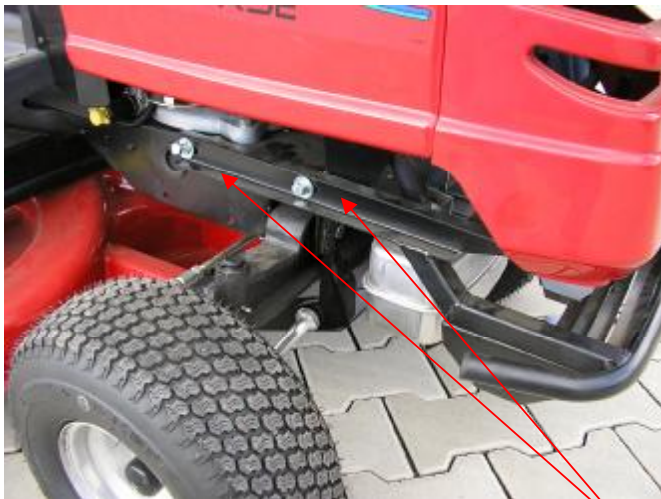
1. Schrauben lösen, die den Haubenträger zunächst auf der rechten Seite des Traktors befestigen.
