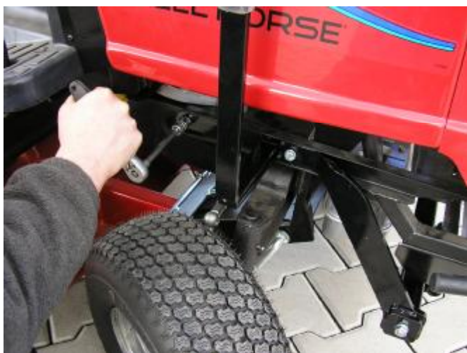
7. Na závěr pečlivě dotáhněte všechny šrouby bočních dílů.
