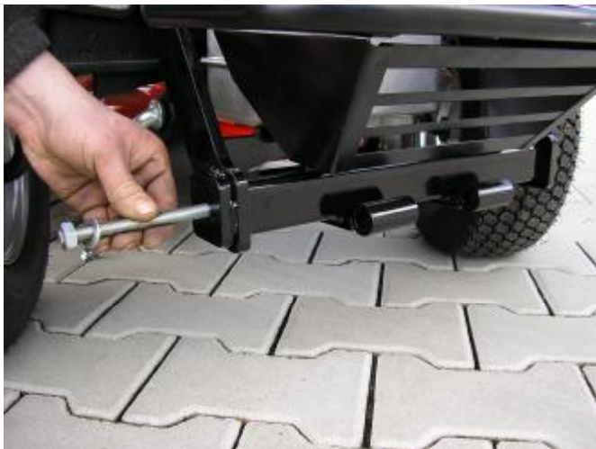
5. Prostrčte svorník bočními díly a zajistěte maticí a podložkou
