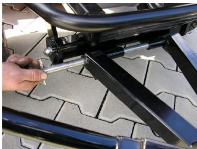
8. Po dotažení rámu přiložte smontovanou sněhovou radlici a zajistěte čepem a závlačkami.
