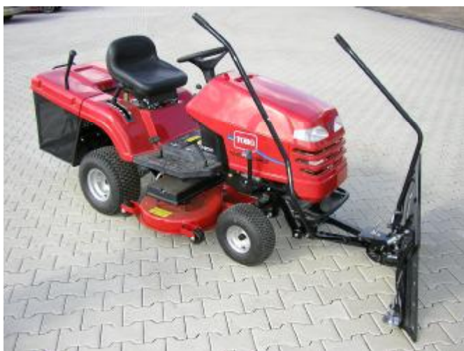
9. Nasad'te ovládací a zvedací páky a zajistěte šrouby
