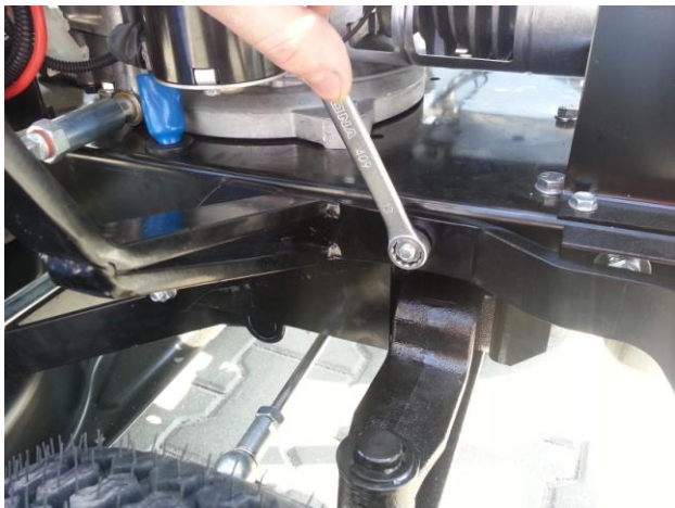
11. Všechny šrouby řádně dotáhněte na obou stranách traktoru pomocí dvou klíčů Alle Schrauben auf beiden Seiten des Traktors mit zwei Schlüsseln sorgfältig festziehen.
