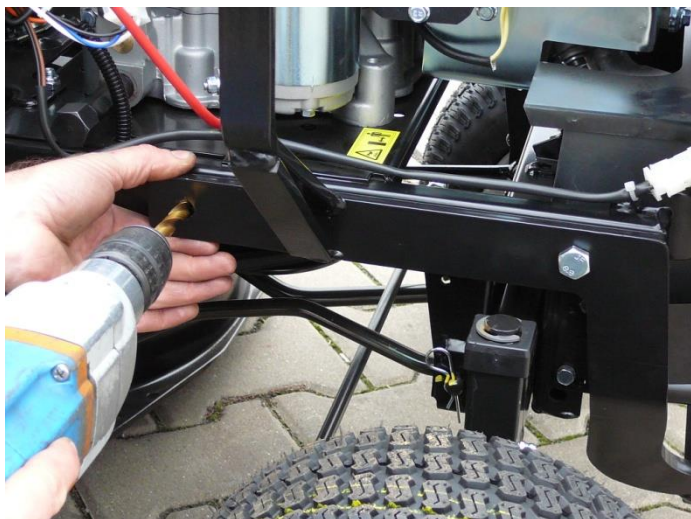
5. Označte a vyvrtejte 4. otvor, vložte šroub.
