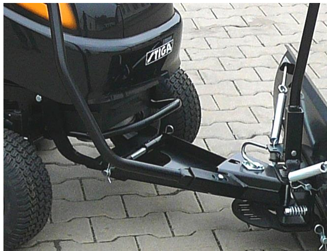
8. Nasazená radlice na rámu traktoru, nasazená zvedací a ovládací páka.
