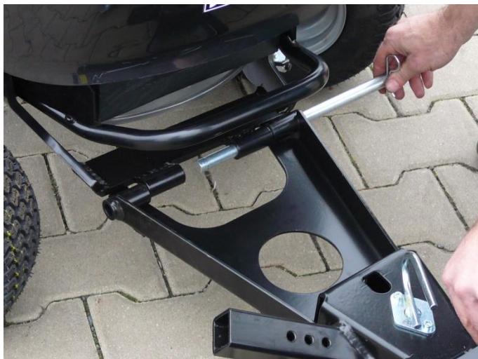
7. Po dotažení rámu nasad'te smontovanou sněhovou radlici. Zasuňte čep a zajistěte závlačkou.
