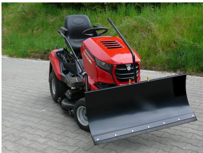
9. Zajištěná radlice na rámu traktoru, nasazená zvedací a ovládací páka.
