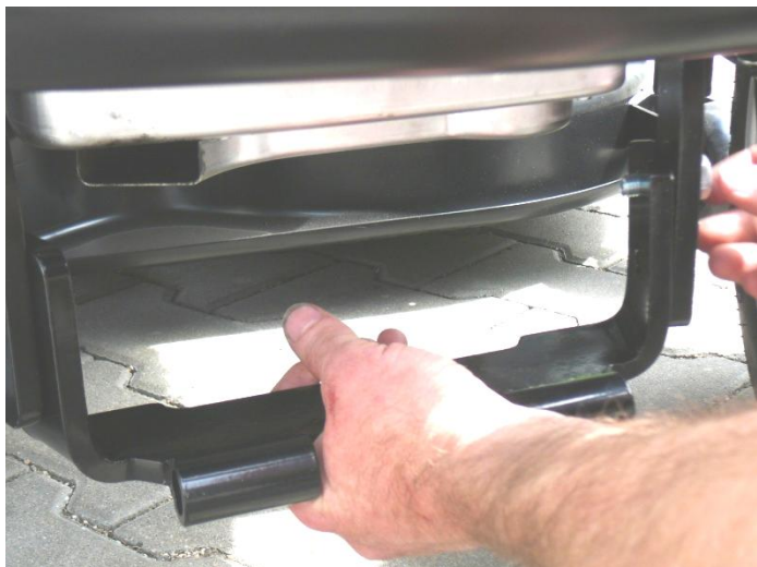
5. Přiložte přední díl rámu a přichyťte šrouby M10 x 30.
