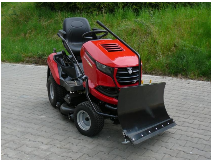
8. Po dotažení rámu nasad'te smontovanou sněhovou radlici. Zajistěte závlačkou.
