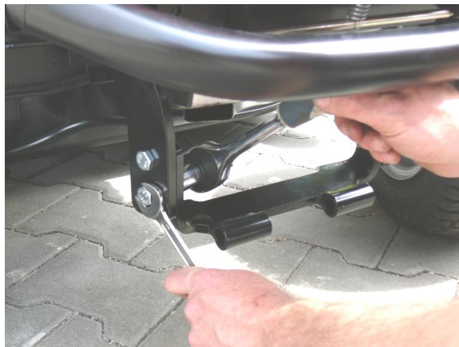
6. Přimontujte přední díl rámu. Šrouby řádně dotáhněte.
