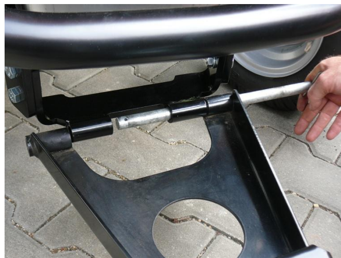
8. Po dotažení rámu nasad'te smontovanou sněhovou radlici. Zajistěte závlačkou.
