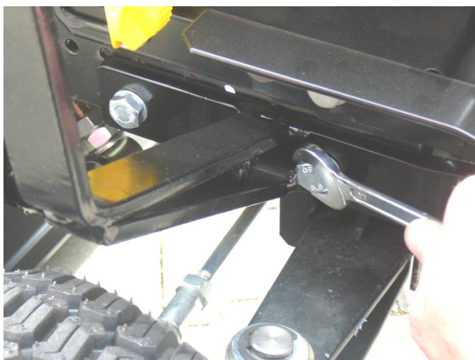
5. Přiložte přední díl rámu a přichyťte šrouby M10 x 30.
