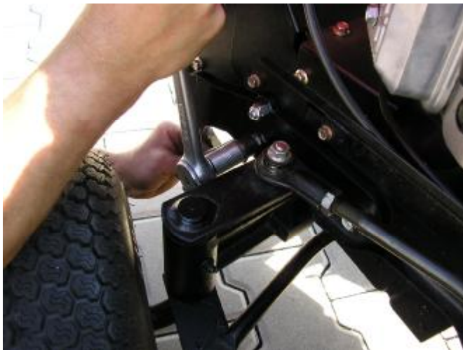
7. Alle Schrauben der Seitenteile auf beiden Seiten des Traktors zum Schluss sorgfältig festziehen.
