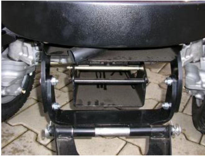
5. Mittelteil anlegen und mit Schrauben, Mutter und Unterlegscheibe sichern.
