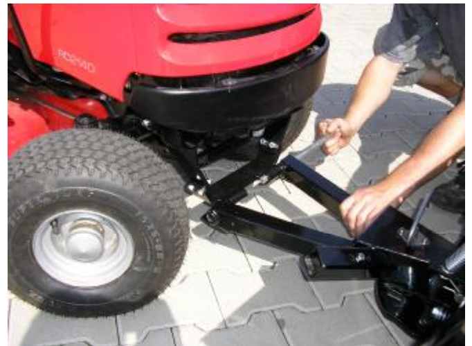
8. Nach dem Festziehen des Rahmens das montierte Schneeräumschild anlegen und mit Bolzen und Splinten sichern.
