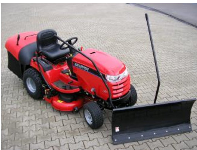
9. Steuer- und Hubhebel aufsetzen und mit Schrauben sichern.
