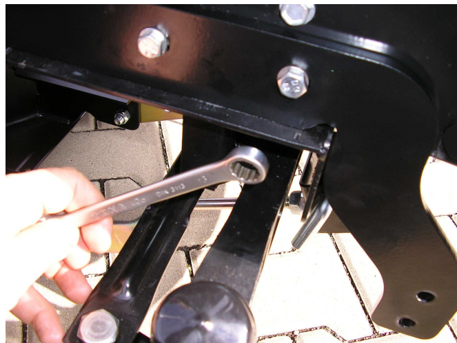
5. Pečlivě dotáhněte oba šrouby, matici přidržte očkovým klíčem.
