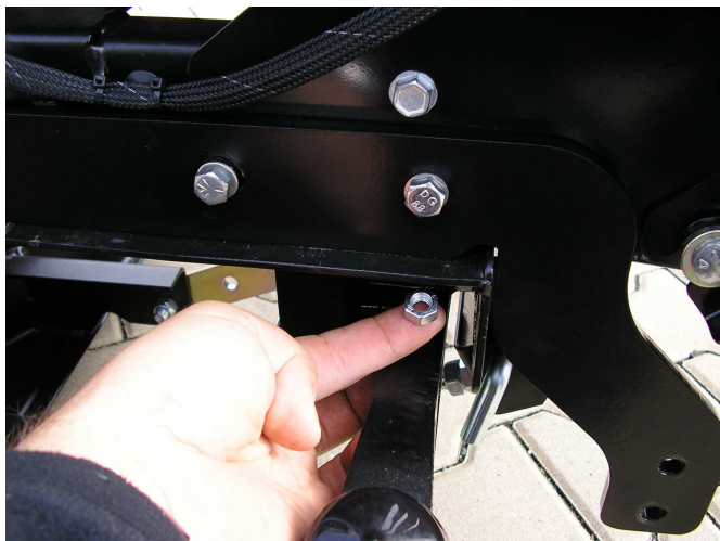
4. Vložte druhý šroub M8 a zajistěte uvnitř šasí maticí . Matice je obtížně přístupná
