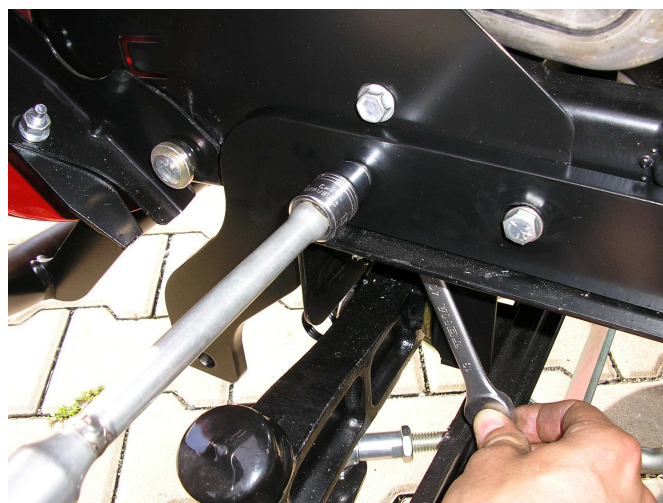
7. Šrouby dotáhněte, matici opět přidržte očkovým klíčem
