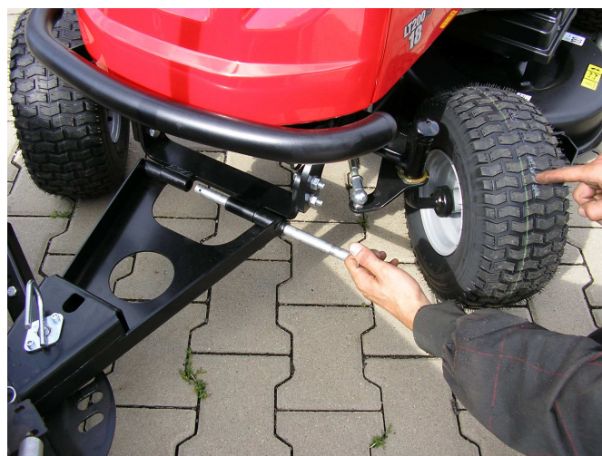
9. Pro připojení radlice vytočte kola do strany a radlici zajistěte čepem.
