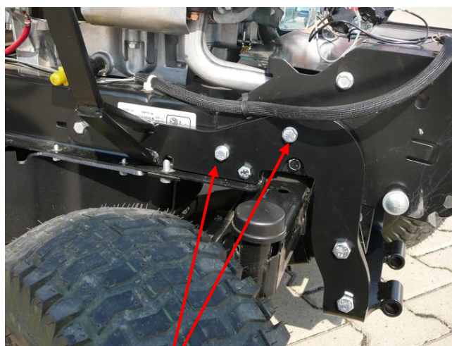
4. Přišroubujte tyto dva šrouby W 5/16" x 1. Označené šrouby mají jiné stoupání závitu ( Δ - na hlavě šroubu ). Jen lehce dotáhněte !
