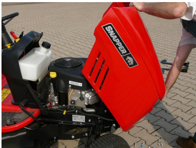
1. Vyjměte žárovky a odmontujte kapotu traktoru.
