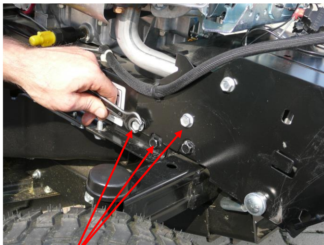
2. Na obou stranách traktoru odmontujte označené 3 šrouby, které vyměníte za nové.
