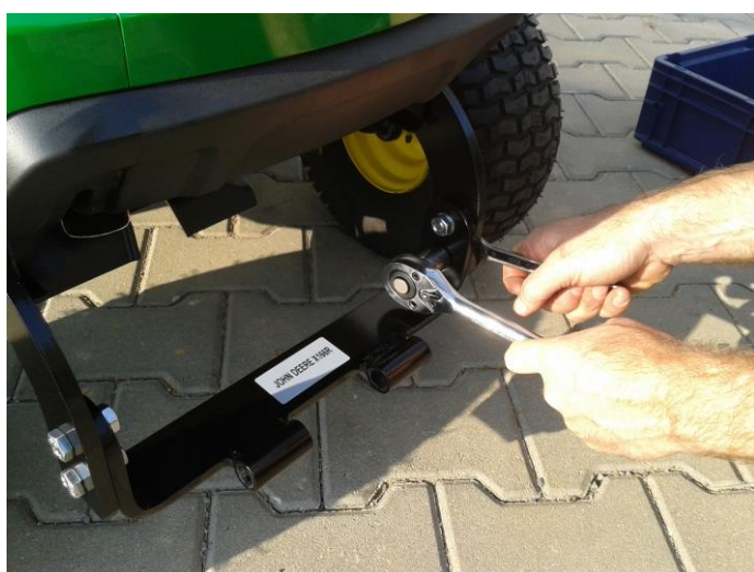
10. Nasad'te šrouby a matice do přední části rámu a všechny řádně dotáhněte klíčem.
