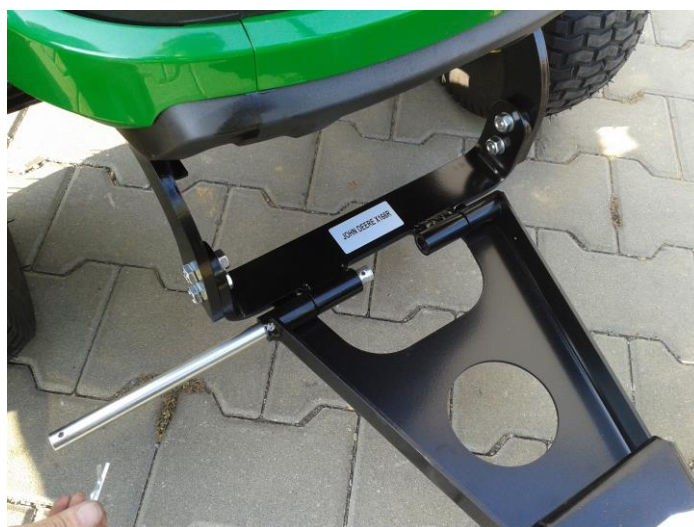
11. Nasad'te radlici a zajistěte čepem.
