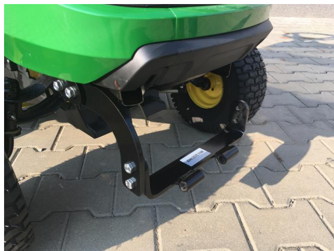
7. Přiložte přední díl rámu a přichyťte šrouby M 10x30 a maticemi.
