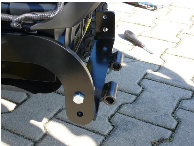
8. Den Vorderteil des Rahmens ansetzen und mit einer Schraube und Mutter befestigen.
