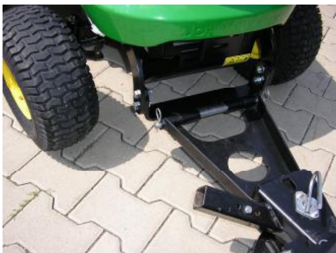
11. Für den Anschluss des Schneeschilds die Räder zur Seite auslenken und den Schneeschild mit Bolzen sichern.
