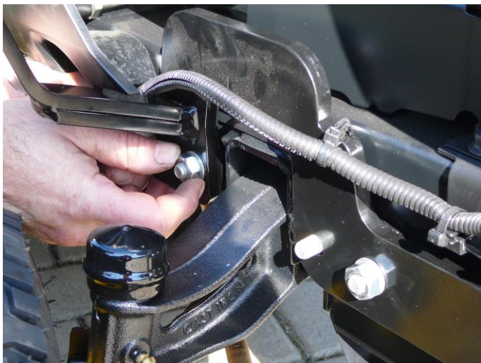
6. Von der rechten Seite des Chassis den Seitenteil des Rahmens mit dem Haken durchziehen.
