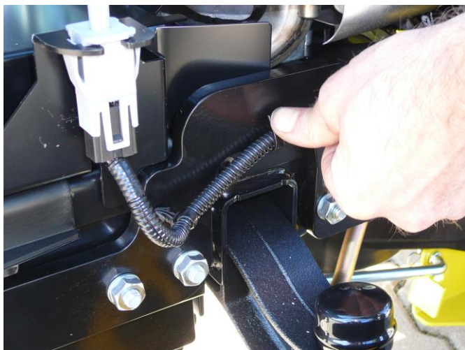
9. Von der linken Seite den Seitenteil des Rahmen ansetzen, anschrauben und anziehen. Das Kabel durch die vorgesehene Öse durchziehen und andrücken
