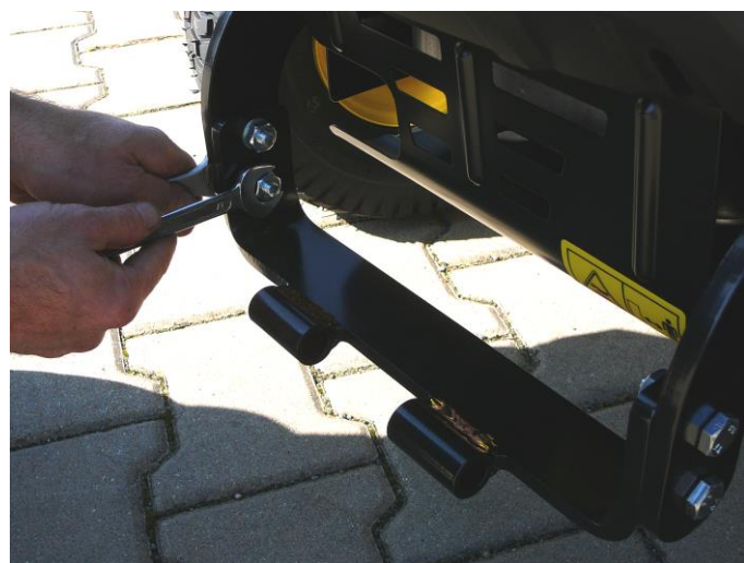
10. Schrauben und Mutter in den Vorderteil des Rahmens ansetzen und alles mit einem Schlüssel richtig anziehen.
