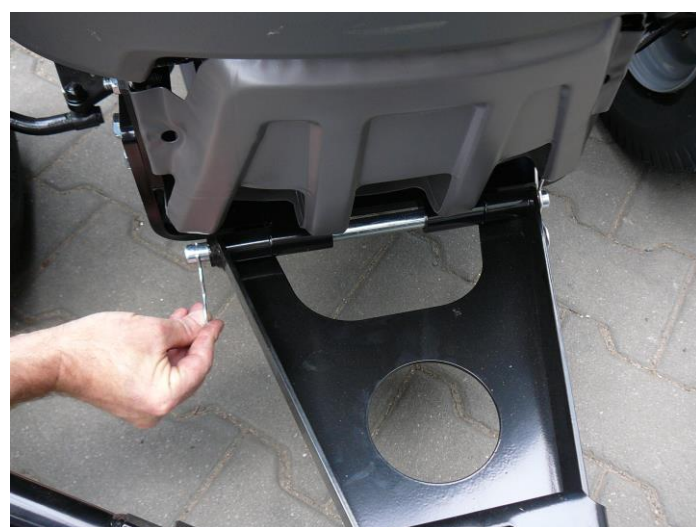
10. Nasad'te radlici a zajistěte čepem. Schneeschild am Rahmen einhängen.
