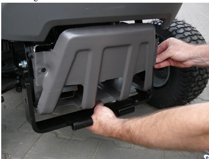
8. Přiložte přední díl rámu a přimontujte šrouby M10x35. Das Mittelstück mit den Schrauben M10X35 montieren.
