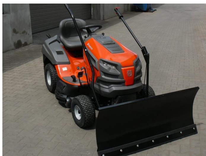
11. Radlice je nyní připravená k použití. Zum Schluß das Schild auf Freigängigkeit prüfen.
