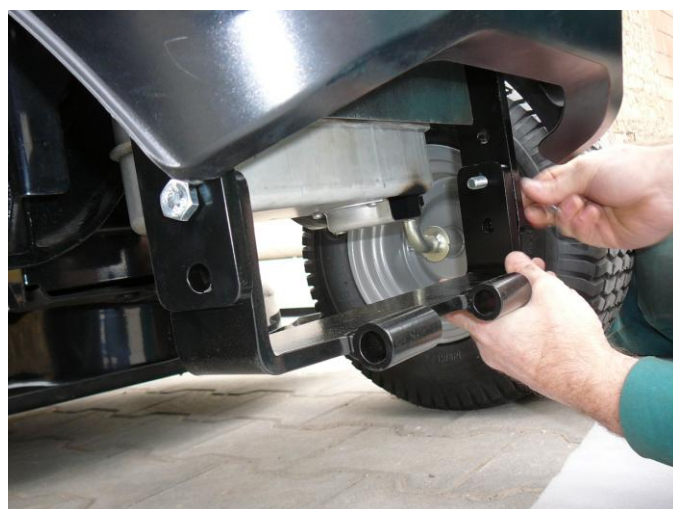
3. Přimontujte druhý bok rámu na levou stranu. Nasad'te střední díl rámu a zajistěte šrouby M10x35 a maticemi. Vše řádně dotáhněte.
