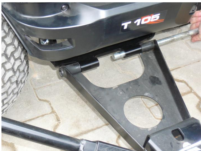
4. Nasad'te radlici a zajistěte čepem a závlačkou.
