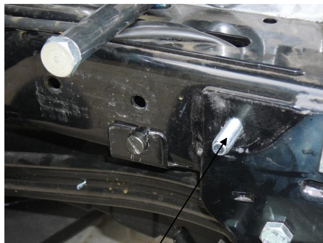
1. Vložte šroub M10x30 z vnitřní strany šasí traktoru .
