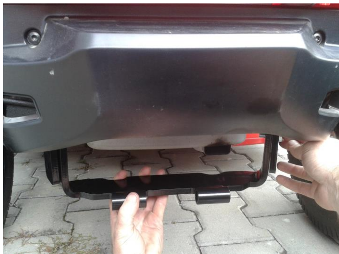
7. Přimontujte střední díl rámu šrouby M 10 x 30 .
