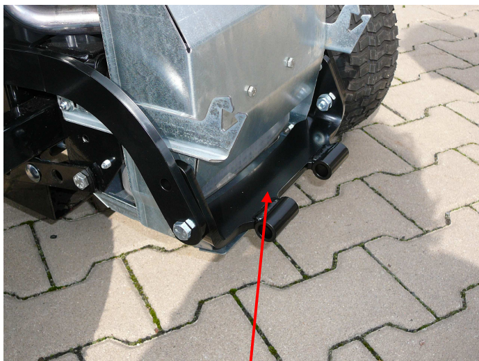
5. Střední díl přimontujte šrouby M10 x 35 dole
